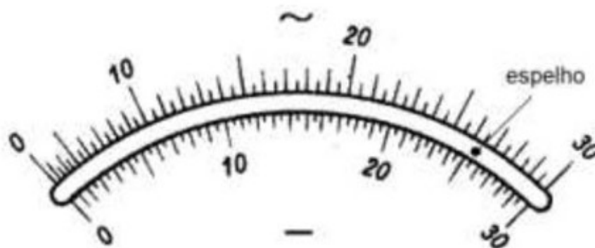
Figura - Espelho para correção do erro de paralaxe (adaptada de LEÃO, Fábio Bertequini; KUROKAWA, Sérgio. Introdução a medidas elétricas. Ilha Solteira: UNESP)
